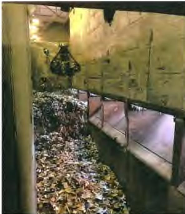
Les grappins permettent de déposer ces déchets dans un four où commence l'incinération.
